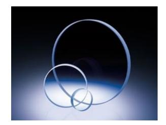
TECHSPEC® N4 N-BK7 Laser Line Windows는 산업용, 그리고 low power laser 장비용으로 이상적입니다. 높은 허용 오차를 갖도록 설계되어 빔의 왜곡과 분산이 최소화됩니다. AR 코팅 처리를 할 경우 코팅 설계 파장에서 0.25% 미만의 반사율을 제공합니다.
