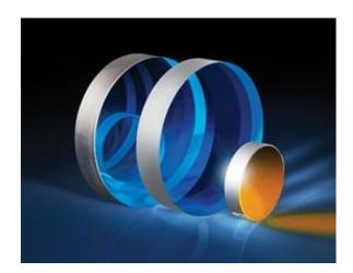
TECHSPEC® Precision Optical Flat Mirrors는 간섭 계측, 이미징 시스템, 레이저 어플리케이션, 광경로 굴절 및 오토콜리메이션 용도에 사용하기 적합한 제품입니다. 모든 미러는  $\lambda/10$  및  $\lambda/20$  표면 평탄도를 비롯해 다양한 코팅 및 기판 옵션을 이용할 수 있습니다. 첫 번째 기판 옵션인 ZERODUR®는 노란색의 유리 세라믹 기판으로서 극히 낮은 열팽창 계수를 특징으로 하며, 온도 변화에 민감한 용도에 사용하기 적합합니다. 두 번째 기판 옵션인 Fused Silica는 광학적으로 투명한 기판으로서 뛰어난 내마모성 및 내구성을 특징으로 하기 때문에 거친 환경에서 사용하기 안성맞춤입니다.
