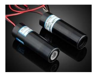
해당 제품은 단독 사용 제품으로 컴팩트한 크기이며 다양한 기능을 제공합니다. 여러 어플리케이션에 사용되는 HeNe 레이저를 대체할 수 있으며 내구성이 우수하고, 크기가 작으며, 제공되는 파장 대역과 출력이 다양하다는 이점이 있습니다. 타원형 출력 빔은 사용자가 조절할 수 있는 글래스 초점 렌즈를 통해 생성됩니다. 원형 출력 빔은 초점 거리가 긴 플라스틱 렌즈를 통해 생성되며 작동 거리가 긴 어플리케이션이나 정렬 작업에 적합합니다. 해당 제품의 어플리케이션으로는 정렬을 위한 파일럿 빔, 바코드 스캐너, 측정, 치수 스캐닝, 로봇 공정 제어, 타깃 지정, 포지셔닝, 분석이 있습니다. 모든 제품군에는 포커싱 도구가 포함되어 있습니다. 또한, 모든 제품군에는 광원 출사구 내부에 렌즈를 장착할 수 있으며 해당 렌즈는 별도로 판매됩니다. 작동 시 별도로 판매되는 전원 공급 장치가 필요합니다.
