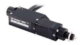
해당 제품은 이동 거리가 최대 50mm이고 분해능이 50nm입니다. PC 제어식 단독 사용 제품으로 스테퍼 모터와 PC 의 RS-232 포트에 직접 연결 가능한 컨트롤러가 포함되어 있으며, 내장된 15V 전원 공급 장치를 사용합니다. 엔코더 버전은 스테퍼 모터에 내장된 250 CPR(Counts per Revolution) Rotary Quadrature 엔코더가 있고 이동 거리와관계 없이 사용이 가능합니다. 해당 제품은 산업 표준 크기의 3/8" 생크(shank)를 갖기 때문에 대부분의 스테이지와호환 가능합니다. 액추에이터 샤프트는 회전하지 않으며 움직이는 스테이지에 토크가 전달되지 않습니다. 액추에이터를 수동으로 사용하는 경우 필요에 따라 PC로 모니터링할 수 있습니다.
