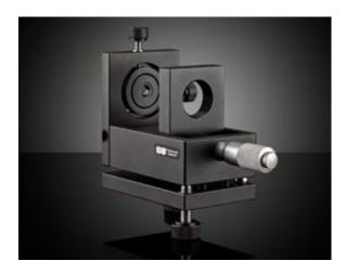
당사에서 취급하는 정밀 개방형 공간 필터(open-style spatial filter)의 메커니즘은 마이크로미터 드라이브를 이용해 스프링이 장착된 듀얼 스테인리스 레일을 따라 움직이는 피사체의 움직임과 볼 베어링을 특징으로 합니다. 핀홀 마운트는 핀홀 & 슬릿 제품 계열의 표준형 ¾" (9.5mm) 디스크를 수용하며 2개의 미세 썸스크류(thumbscrew)를 이용해 X-Y 축을 조절할 수 있습니다. 전체 어셈블리는 2개의 미세 썸스크류로 X-Y 두 개의 축을 조절해가며 짐벌 틸트테이블에 장착할 수 있습니다. 짐벌 플랫폼 베이스에는 1개의 ⅓-20 탭홀이 있어 포스트나 기타 포지셔닝 장치를 쉽게 장착할 수 있습니다. 어플리케이션 노트 '공간 필터의 이해'를 참고하시면 레이저 용도에 맞는 적절한 부품 선택에 도움이 될 수 있습니다.
