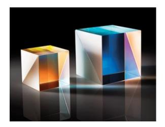
TECHSPEC® Broadband Non-Polarizing Cube Beamsplitters는 정밀 공차를 가진 한 쌍의 고정말ight angle prism이 서로 접합된 구조로서 이 중 한 프리즘의 빗변에는 금속 유전체 코팅이 입혀져 있습니다. 편광 의존성이 낮은 금속 유전체 하이브리드 코팅은 S-및 P-편광 상태에서 투과율 및 반사율이 서로 6% 이내가 되도록 합니다. 이 빔 스플리터는 지정된 파장 범위에 걸쳐 평평한 스펙트럼을 제공하며 입사각 또는 수렴/발산 빔의 변화로 인해 야기되는 영향을 줄여줍니다.
