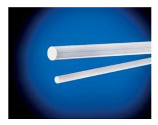
해당 제품은 광택 처리가 된 한쪽 단면에서 반대편으로 이미지를 투과시킵니다. 제품을 공간에 맞게 구부리거나 그 대로 사용할 수 있어 손실 없이 빛이 투과됩니다. 해당 제품은 단면이 연마 및 연삭 가공된 용융 글래스 광섬유 로드 입니다. 제품을 글래스 오븐에 넣거나 분젠 버너를 사용하여 골고루 열을 가하면 힘으로 구부릴 수 있습니다. 해당 제품은 광섬유 이미징에 적합합니다. 일관된 광섬유 배열로 이미지를 릴레이하며, 표준 및 고해상도 제품이 다양한 길이로 제공됩니다.
