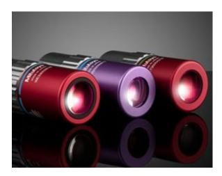
Mitutoyo NIR, NUV, and UV LCD Infinity Corrected Objectives는 표준 M Plan Apo 및 M Plan Apo SL 시리즈 대물렌즈의 장점에 향상된 스펙트럼 범위가 결합된 제품입니다. NIR 대물렌즈는 480 - 1800nm에서 보정 처리가 되어, 반도체 및 통신 검사나 상용 Nd:YAG 레이저를 사용한 레이저 커팅에 이상적으로 사용할 수 있습니다. HR 시리즈는 개구수(NA)가 증가하여, 보다 작은 스폿 크기와 더 높은 해상도를 제공합니다. Mitutoyo NIR, NUV, and UV LCD Infinity Corrected Objectives는 일반 LCD 글래스의 두께에 대한 보정 기능이 있습니다. Mitutoyo NIR, NUV, and UV LCD Infinity Corrected Objectives는 각각 532nm, 355nm, 266nm의 2차, 3차, 4차 YAG 고조파에서 뛰어난 성능을 발휘합니다.
