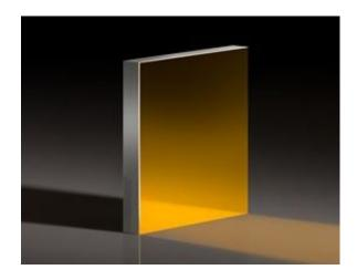
"TECHSPEC® ZERODUR®  $\lambda$ 10 First Surface Mirrors는 온도의 변화가 중요한 용도에 이상적으로 사용할 수 있는 제품입니다. ZERODUR® 기판은 열팽창 계수(CTE)가  $\pm$ 0.10 x 10-6/°C이며 대다수의 글래스 기판보다 계수의 자릿수가 낮습니다. 이 처럼 열팽창 계수가 낮으면 온도가 변화하거나 조명 광원의 강도가 바뀌더라도 미러는 일정한 반사 웨이브프론트를 가질 수 있습니다. TECHSPEC® ZERODUR®  $\lambda$ 10 First Surface Mirrors는  $\lambda$ 10의 표면 평탄도와 20-10의 표면 정밀도로 미세하게 연마된 기판을 특징으로 합니다. 또한 다양한 금속 코팅 및 강화 금속 코팅을 적용할 수 있어 VIS와 IR 스펙트럼을 둘 다 필요로 하는 용도에 쉽게 결합할 수 있습니다."
