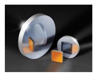
TECHSPEC® N/20 First Surface Mirrors는 업계 최고 수준의 표면 정밀도와 품질 사양에 맞춰 연마된 제품으로서 반사 웨이브프론트 에러를 최소화합니다. 이 미러는 열팽창 계수가 낮은 정밀 용융 실리카 기판을 특징으로 하며, 다양한 코팅 옵션을 적용할 수 있어 가시광부터 적외선까지 넓은 스펙트럼을 포괄하는 용도와 결합이 가능합니다. TECHSPEC® N/20 First Surface Mirrors는 빔을 조정하고 반사하는 용도에 사용하기 적합하며 다양한 크기, 두께 및코팅 옵션과 함께 제공됩니다.
