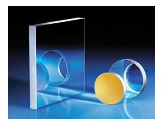
해당 제품은 글래스 기판의 전면에 고반사율 코팅을 증착한 것이 특징입니다. 코팅 종류로는 450 - 10000nm에서 높 은 반사율을 제공하는 Enhanced Aluminum, Protected Gold 및 Protected Silver 코팅이 있습니다. 코팅 표면은 입사 광을 반사하는 방향으로 배치합니다. 해당 제품은 원형, 정사각형, 사각형 모양으로 제공됩니다. 또한, 미러를 45°로 장착하여 입사광을 90°로 꺾어야 하는 어플리케이션에 적합합니다. 해당 제품은 다양한 <u>Optical Mount(광학 마운</u> <u>트</u>)에 쉽게 장착할 수 있어 어플리케이션과의 통합이 용이합니다.
