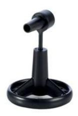
Coherent® High Sensitivity Optical Power Sensors는 나노와트에서부터 낮은 밀리와트의 CW 레이저 측정 용도로 설계된 반도체 센서입니다. 이 반도체 센서는 UV부터 IR까지 감지할 수 있으며 분리 가능한 light shield를 특징으로 합니다. 또한 attenuator를 사용하면 최대 5W까지 파워를 증폭할 수 있습니다.
