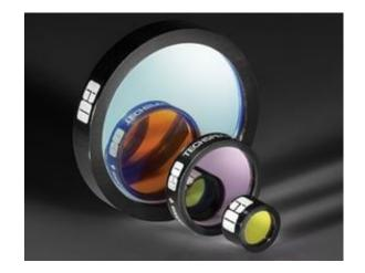
해당 제품은 좁은 파장 대역을 선별적으로 투과하고 그 외 다른 파장 대역을 차단하는 데 사용됩니다. 바이오테크, 바이오메디컬, 정량적 화학 분석 등 여러 어플리케이션에 적합합니다. 밴드패스 간섭 필터는 일반적으로 임상화학, 환경 테스트, 측색(colorimetry), 원소 및 레이저 라인 분리, 불꽃 광도법, 형광, 면역측정 등의 어플리케이션용 계측 기기에 사용됩니다. 또한, 아크램프(arc lamp)나 가스방전등(gas discharge lamp)에서 스펙트럼 선을 분리된 형태로 각각 선택하거나 아르곤(Ar), 크립톤(Kr), Nd:YAG 및 기타 레이저에서 특정 스펙트럼 라인을 분리하는 데도 사용됩 니다. 밴드패스 간섭 필터는 보통 <u>레이저 다이오드 모듈</u> 및 <u>LED</u>와 함께 사용합니다.
