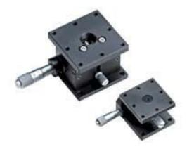
정밀한 수직의 translation 스테이지는 광학 부품을 위한 micrometer 움직임을 제공합니다. Knob의 회전 한번은 0.5mm 움직임과 같습니다. 25mm와 40mm의 높이조절은 ±2.5mm이고 60mm와 80mm은 ±5.0mm 입니다.
